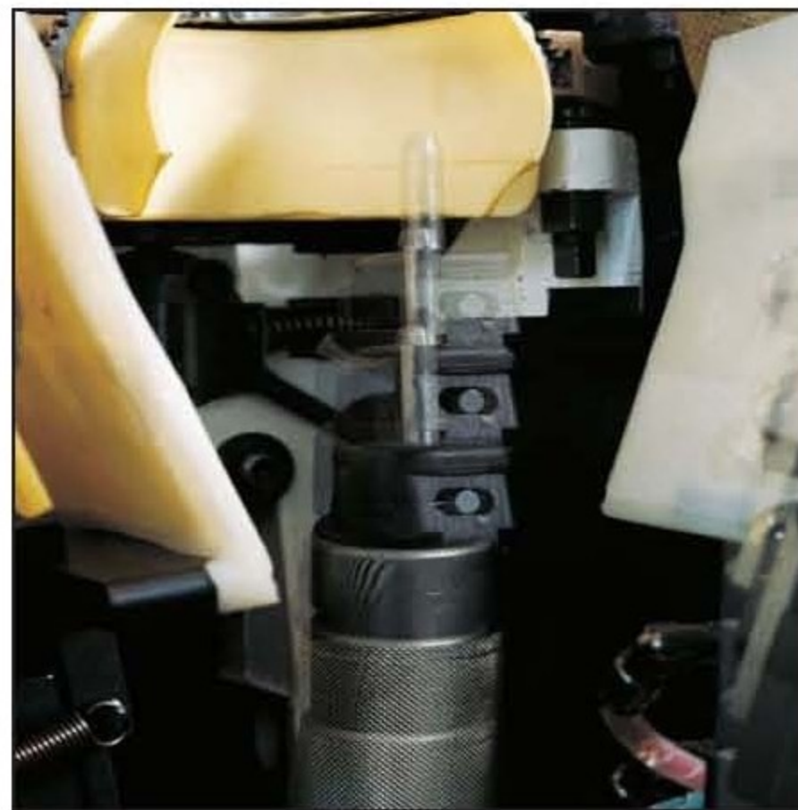
Piantone programmabile con ghiera regolabile. Programmable last post with adjustable ring nut. Bigornia programable con virola regulable. Bigorne programmable avec embout réglable.
